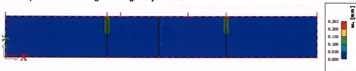
Rys.41. Zarysowanie powierzchni górnej płyty stropu nad częścią techniczną dla kombinacji SGU-char
